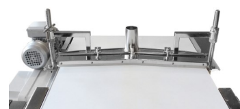
Horný čistič dopravníkov parou
